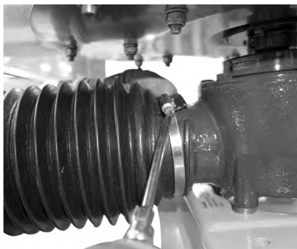
Fig. 14: Påsætning af kardanaxselbeskyttelsen
