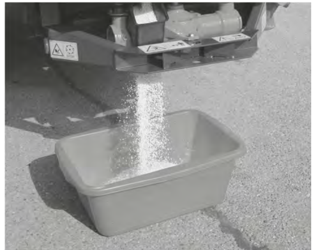
Fig. 37: Udførelse af kalibreringsprøve
