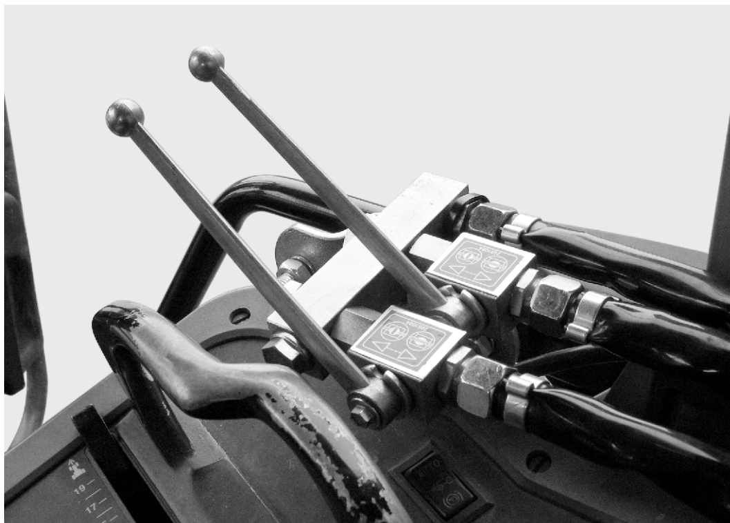
Fig. 28: Spjældaktivering for tovejsenheden
