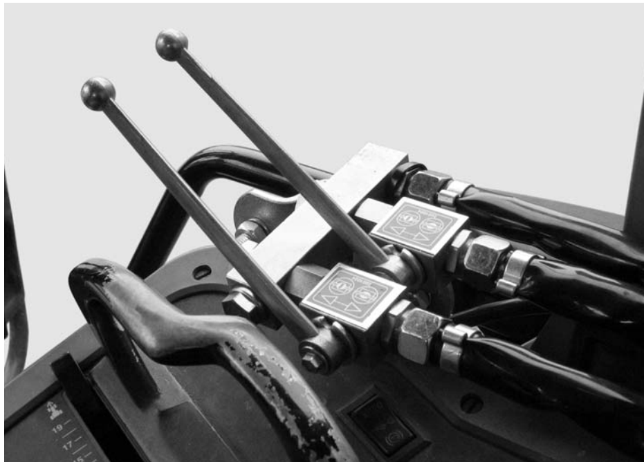
Billede 7.12: Skyderaktivering for tovejsenheden Med tovejsenhedens kuglehaner kan doseringskyderne aktiveres enkeltvis.
