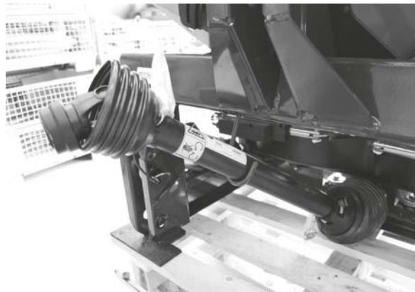
Billede 7.14: Opbevaring af kardanakslen og hydraulikslangerne
