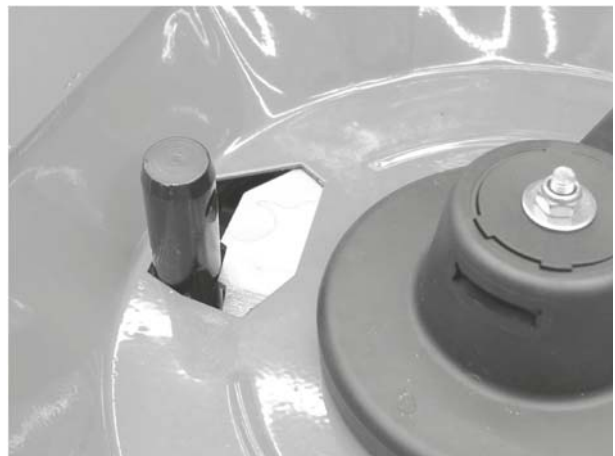
Billede 12.5: Trækstangbolt i doseringsåbningen
