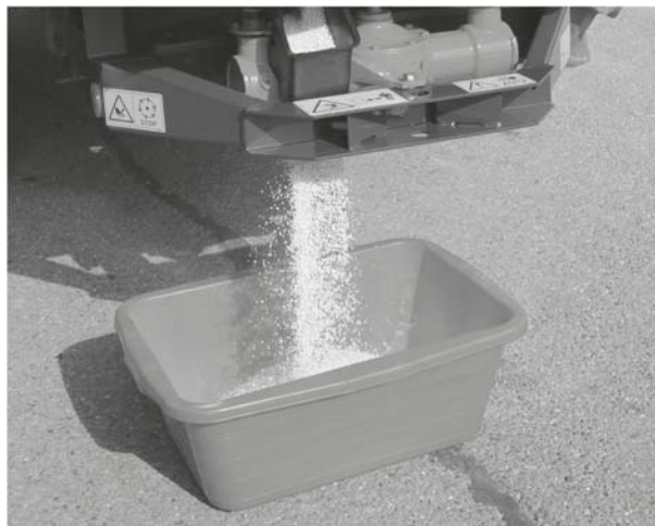
Billede 9.7: Udførelse af en drejeprøve
