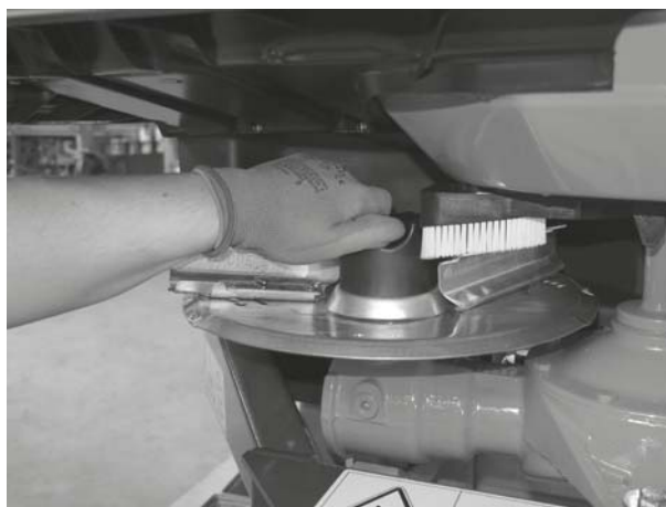
Billede 9.8: Skru kalotmøtrikken fast
