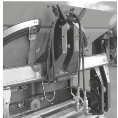
Billede 7.14: Opbevaring af kardanakslen og hydraulikslangerne
