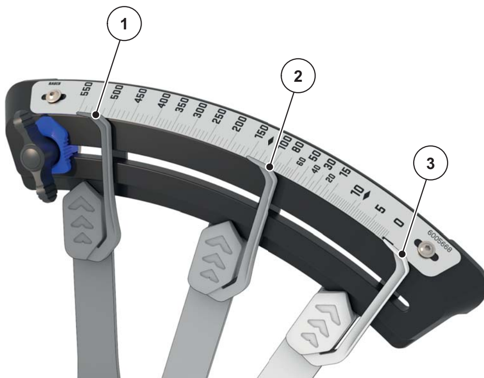
Billede 7.13: Doseringsskyderens positioner
