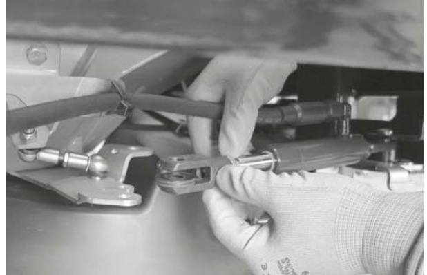
Billede 12.8: Træk hydraulikcylinderen ud
