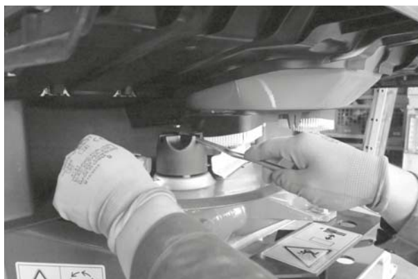
Billede 12.13: Løsn kalotmøtrikken
