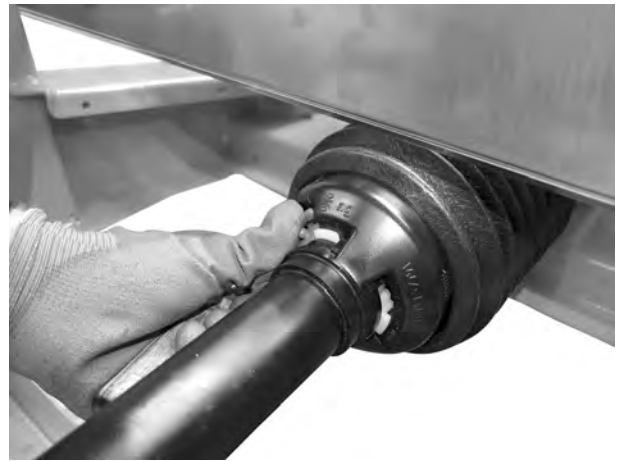
III. 15: Fissaggio della protezione dell'albero cardanico
