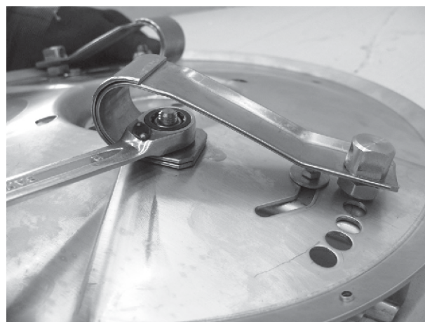
III. 86: Rimozione delle viti
