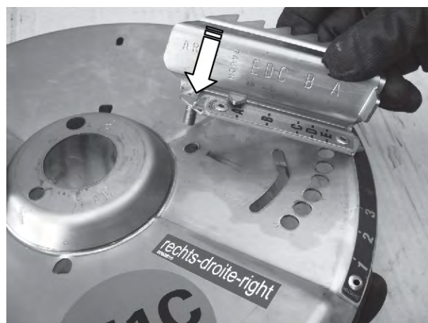
III. 90: Montaggio della paletta principale
