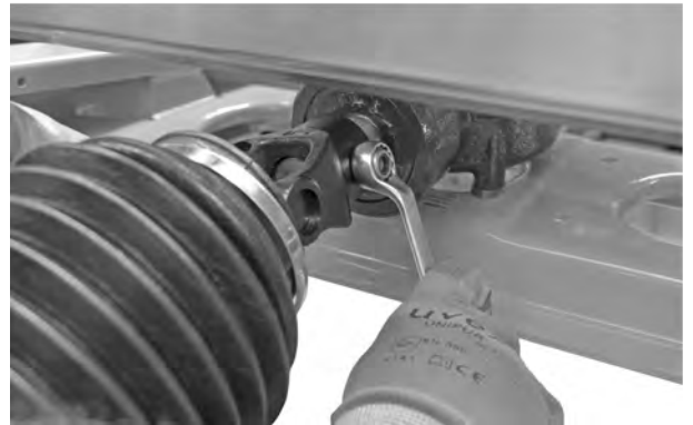
III. 13: Collegamento dell'albero cardanico
