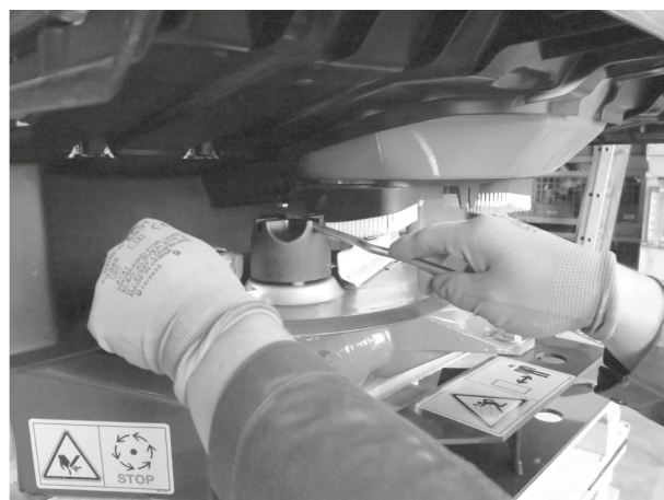
Fig. 35: Loosening the cap nut
