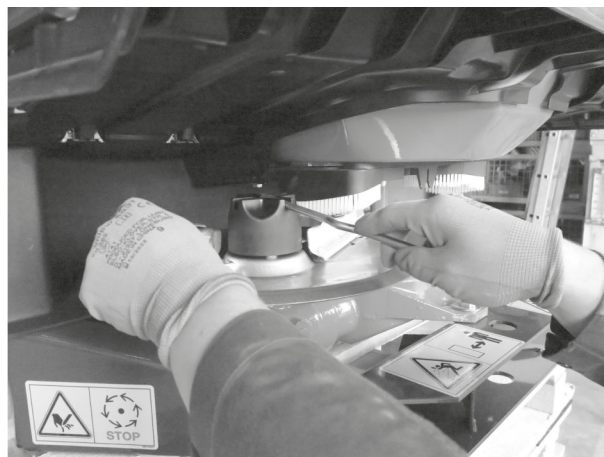
Fig. 35: Dévisser l'écrou borgne
