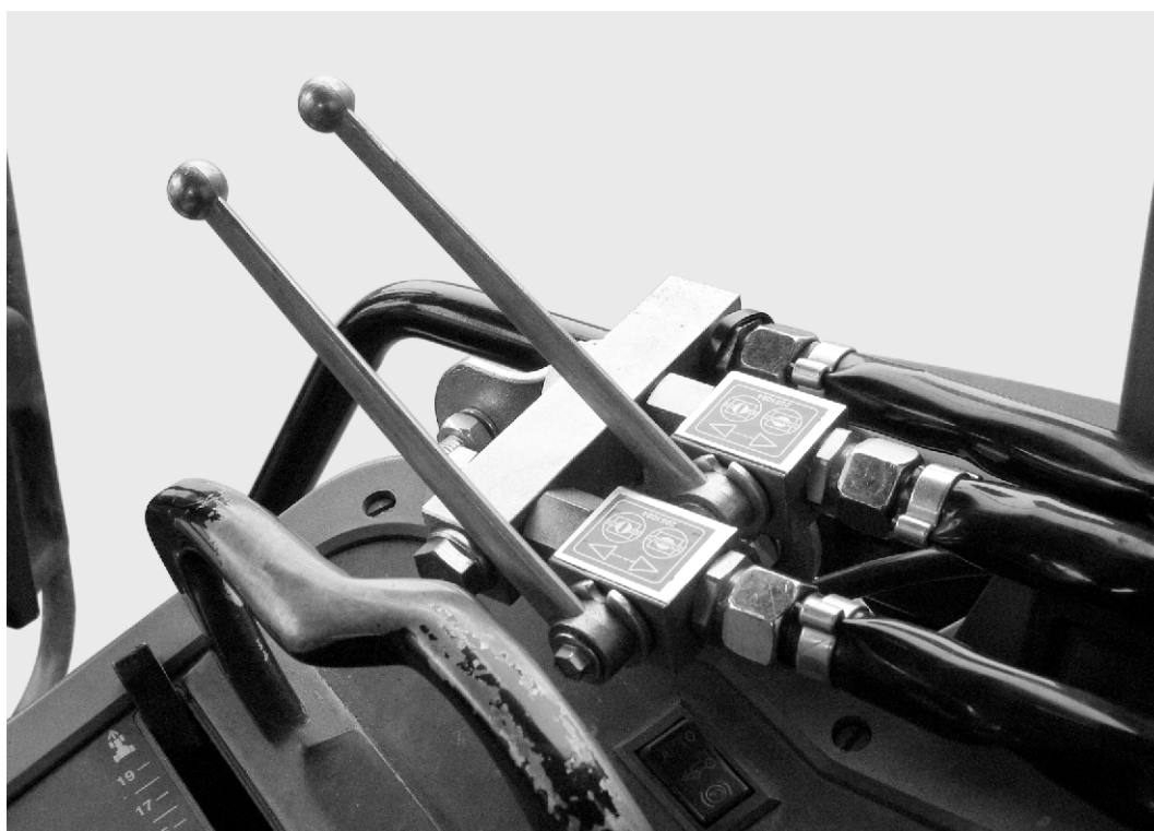
Fig. 28: Commande des vannes du répartiteur à deux voies
