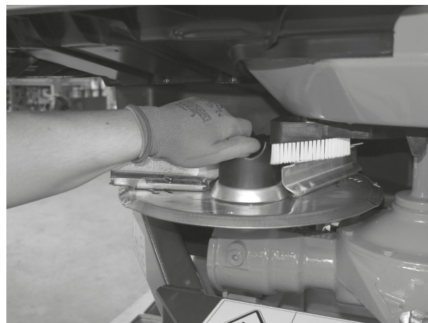
Fig. 38: Visser l'écrou borgne
