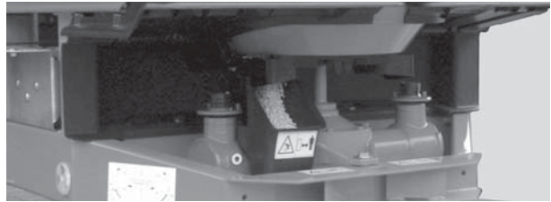
Мал. 8.7: Спускна труба під випускним отвором
