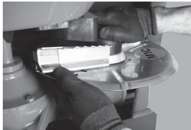
Мал. 8.9: Закручення ковпачкової гайки
