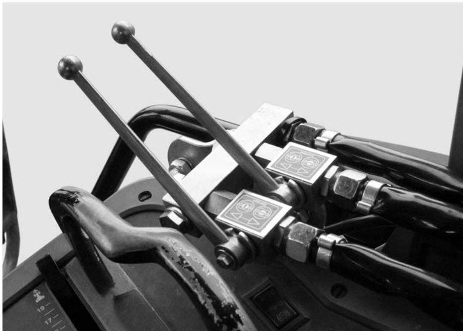
Мал. 6.30: Гідравлічний пристрій керування заслінкою двоходового блока
