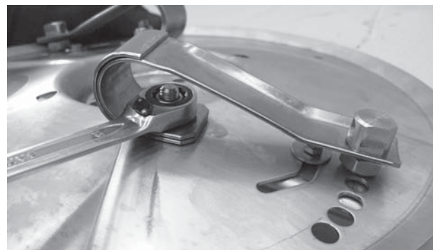
Мал. 9.30: Кріплення плоскої пружини
