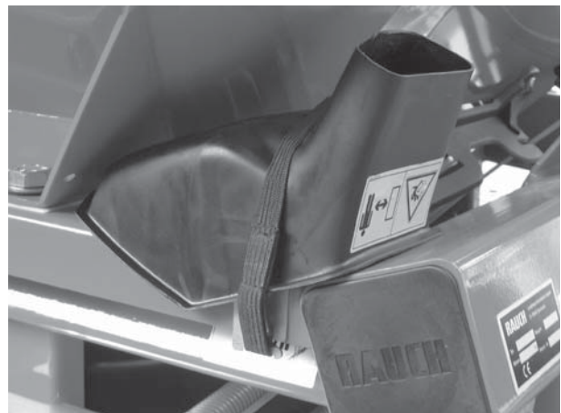
Мал. 8.3: Спускна труба для встановлення норми внесення добрива
