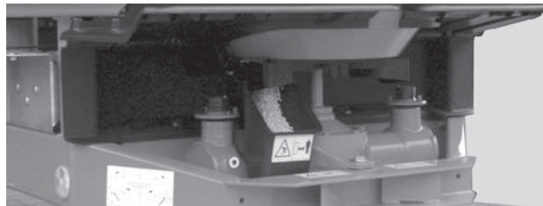
Mynd 8.7: Renna fyrir dreifingarprófun undir útrennslisopi
