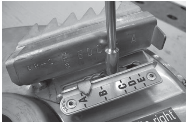
Obrázok 9.27: Rozmetacia lopatka na rozmetacom disku
