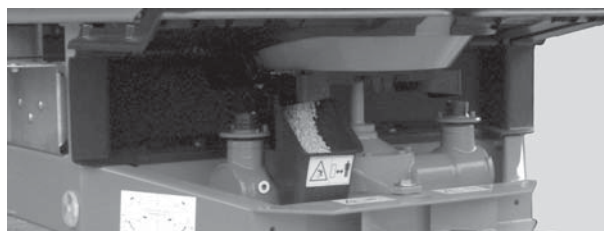
Joonis 8.7: Tasakaalustuskatse renn väljastusava all
