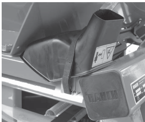
Obrázek 8.3: Skluzný žlab stáčecí zkoušky
