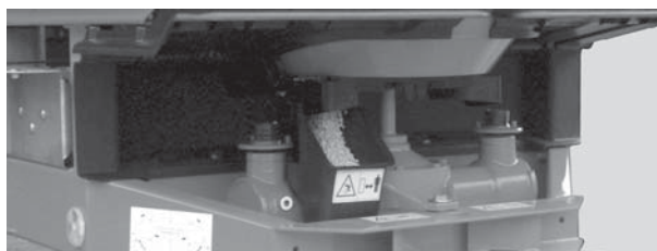
Slika 8.7: Žleb za preizkus trosilnika pod izstopom gnojila
