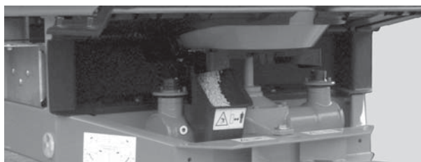
Imagine 8.7: Jgheabul probei de rotire sub scurgere
