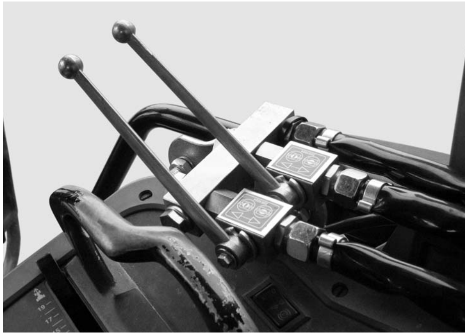
Imagine 6.30: Acționarea cursorului unității cu două căi:
