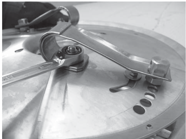
Imagine 9.22: Demontarea șuruburilor
