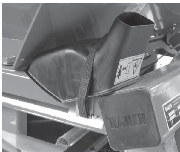
Imagine 8.3: Jgheabul probei de rotire
