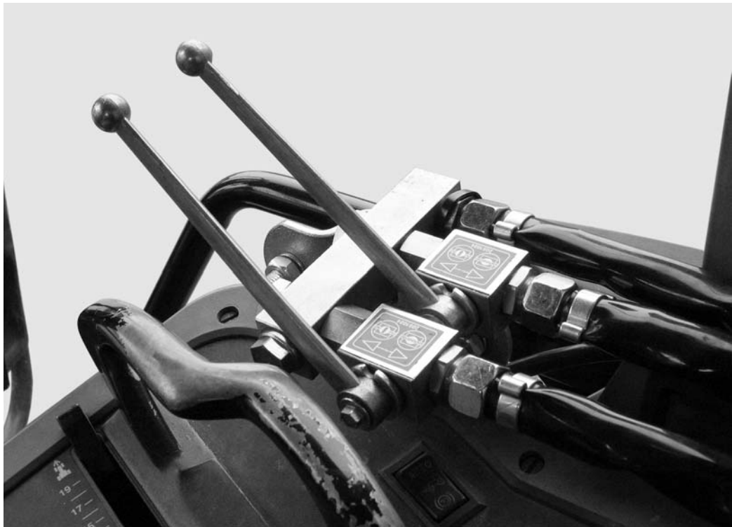
6.30 ábra: Reteszzerkezet kétutas egységgel
