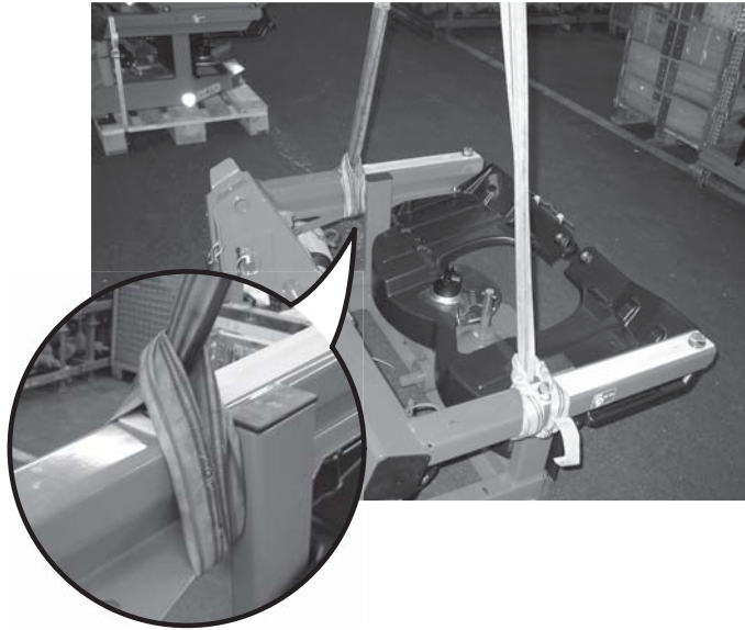
6.1 ábra: A vázkeret felemelése
