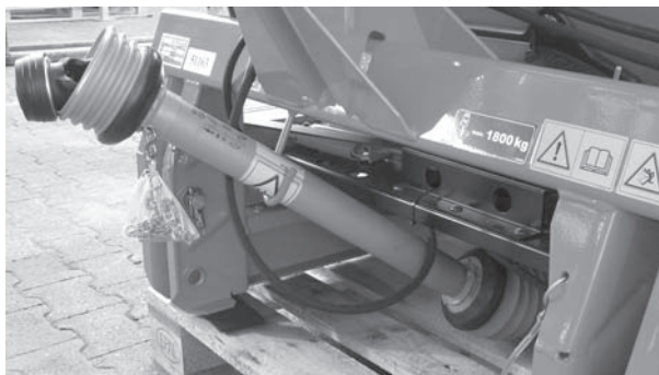
Billede 6.34: Fralægning af kardanakslen og hydraulikslangerne
