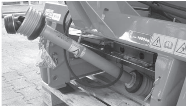
Afb. 6.34: Afleggen van de cardanas en hydraulische slangen
