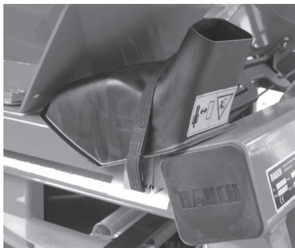
Afb. 8.3: Glijgoot voor de afdraaiproef
