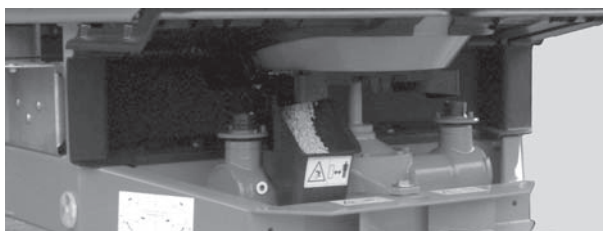
Afb. 8.7: Glijgoot voor de afdraaiproef onder uitloop
