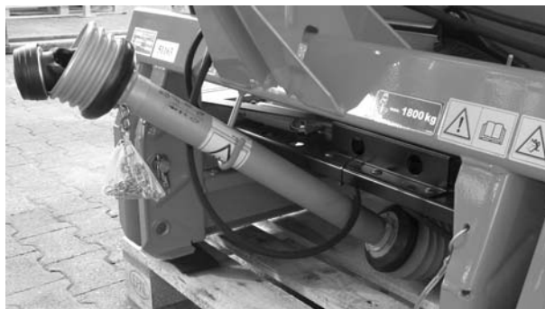
6.34 pav.: Kardaninio veleno ir hidraulinių žarnų padėjimas
