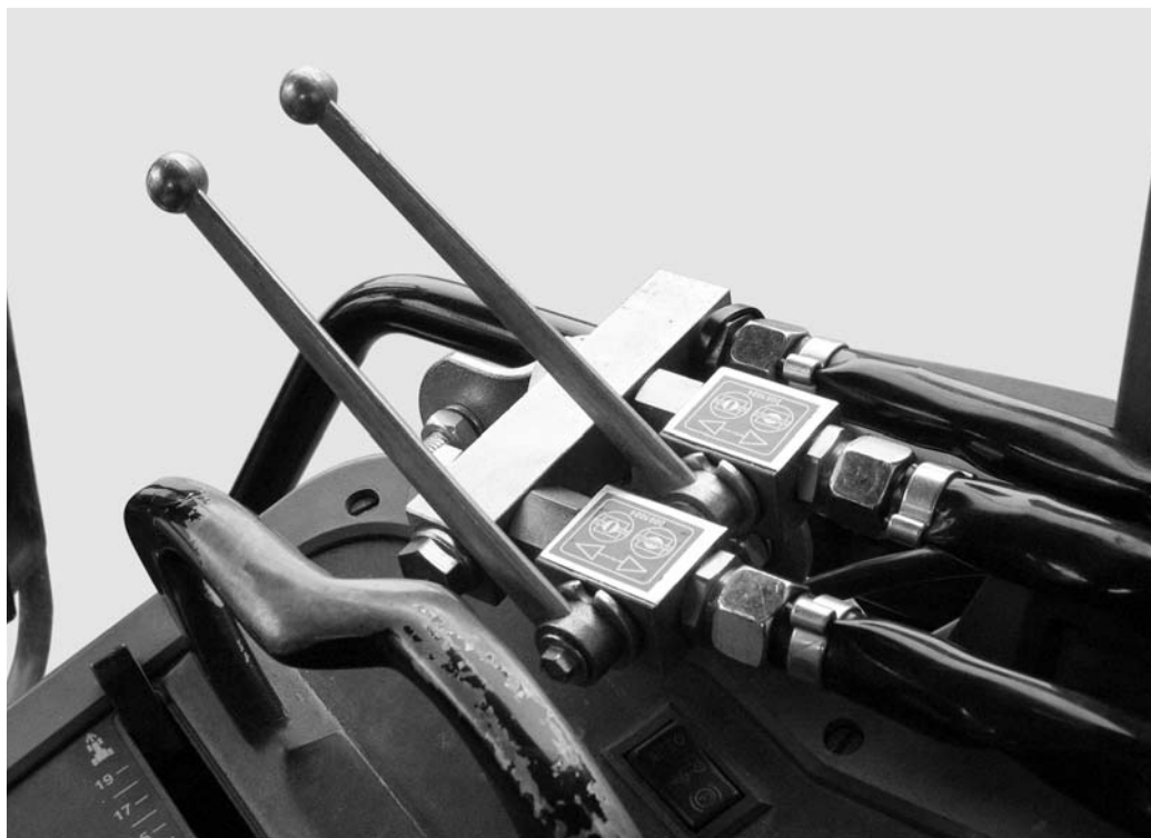
6.30 pav.: Dvikrypčio bloko sklendžių valdymo įtaisas
