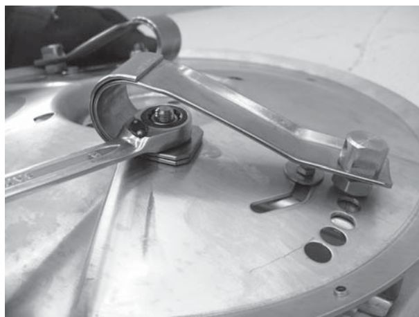
9.22 pav.: Varžtų išėmimas
