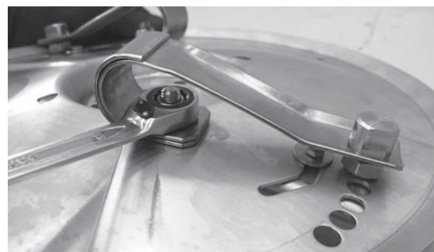
9.30 pav.: Prizminės spyruoklės pritvirtinimas
