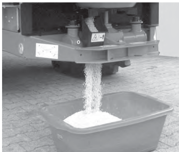
Rysunek 8.8: Przeprowadzenie próby wysiewu
