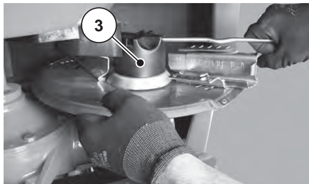
Rysunek 8.6: Odkręcanie nakrętki kołpakowej
