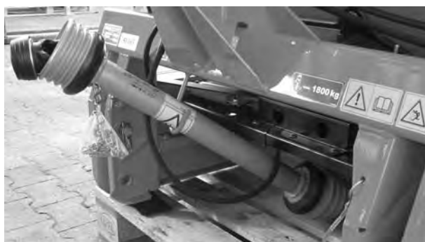
Rysunek 6.34: Przechowywanie wału przegubowego i węży hydraulicznych
