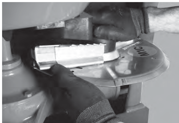
Rysunek 8.9: Dokręcanie nakrętki kołpakowej
