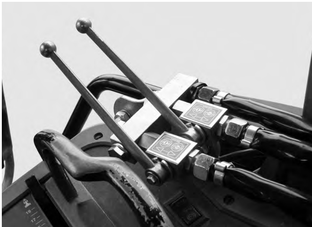
Rysunek 6.30: Układ sterowania zasuw z zespołem 2-drogowym
