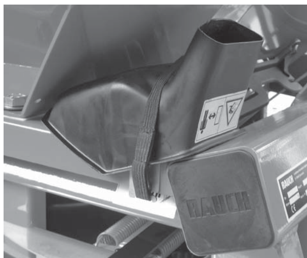
Imagen 8.3: Plano inclinado de prueba de extracción
