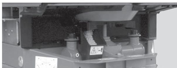
Imagen 8.7: Plano inclinado de prueba de extracción bajo la boca de salida
