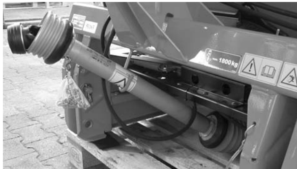
Imagen 6.34: Depositar el eje articulado y los latiguillos hidráulicos
