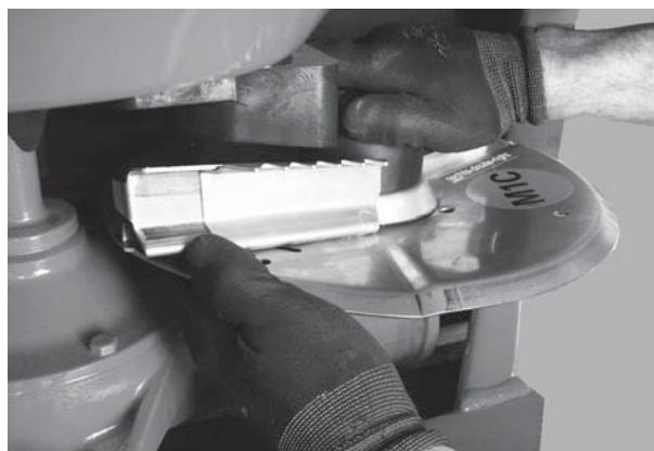
Figura 8.9: Avvitare il dado a cappello
