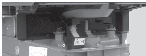
Figura 8.7: Scivolo per il test di taratura sotto lo scarico
