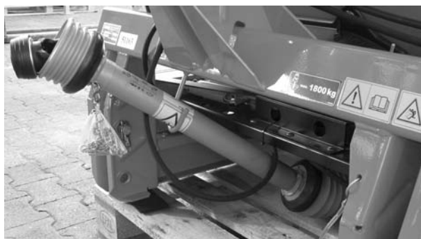
Figura 6.34: Deposito dell'albero cardanico e dei tubi flessibili idraulici
