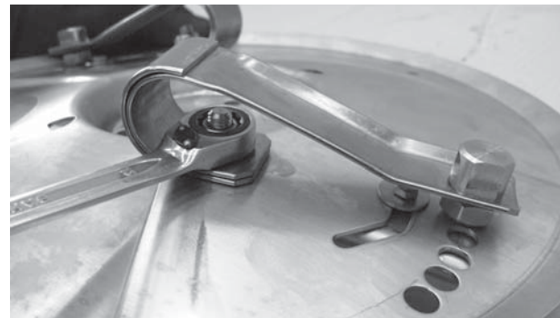
Figura 9.30: Fissaggio della molla piatta
