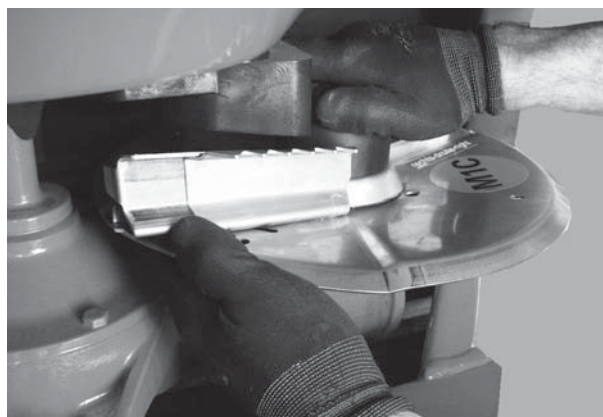
Bild 8.9: Skruva fast hattmuttern
