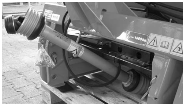
Bild 6.34: Placering av kraftöverföringsaxel och hydraulslangar
