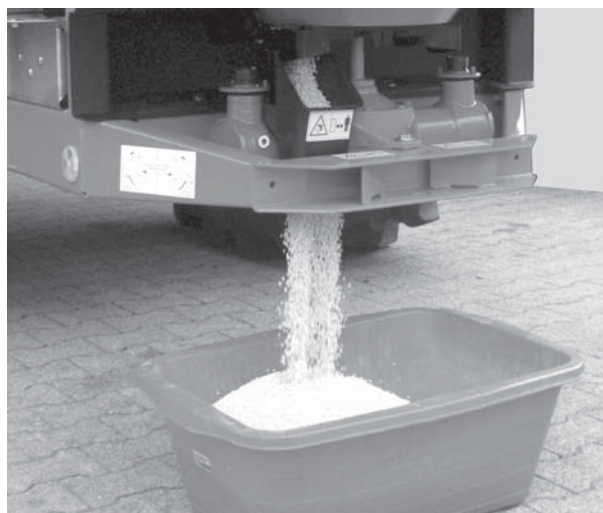
Bild 8.8: Genomförande av utmatningsprovet
