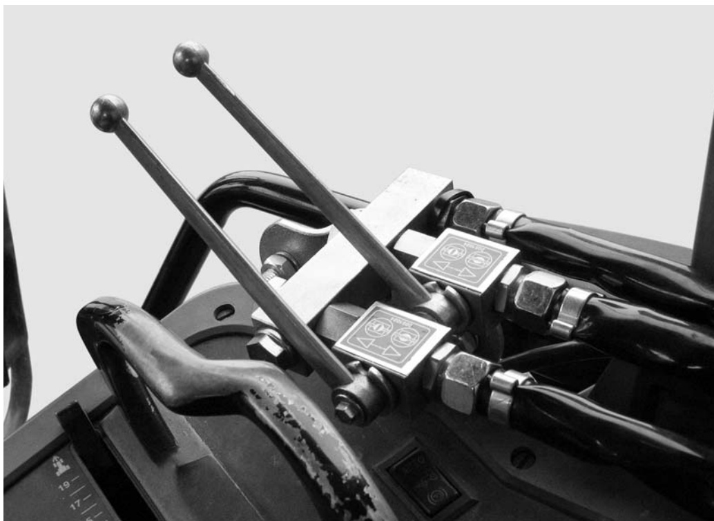
Bild 6.30: Slidstyrning med tvåvägsventil
