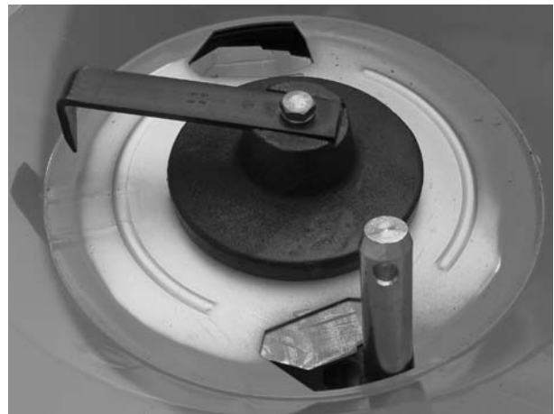
Bild 9.8: Bult för nedre ledarm i doseringsöppningen
