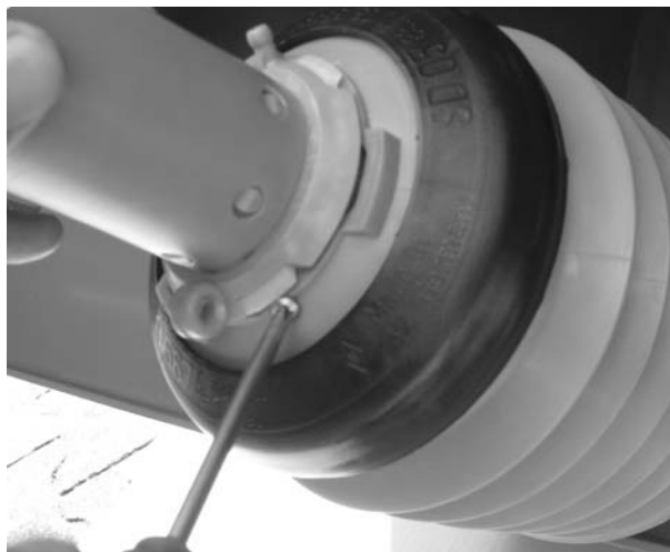
Bild 6.22: Skydd för kraftöverföringsaxel
