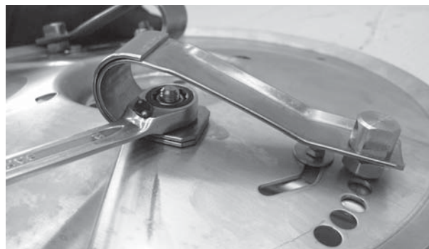
Bild 9.30: Fastsättning av bladfjädersnåren
