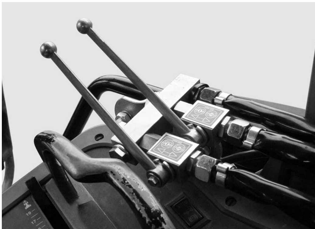
Slika 6.30: Hidraulično upravljanje zasunima za doziranje preko dvorazvodne jedinice
