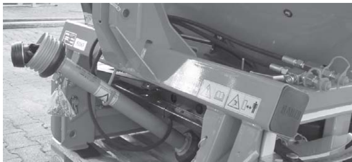
Фиг. 5.25: Складиране на шарнирния вал и на хидравличните маркучи
