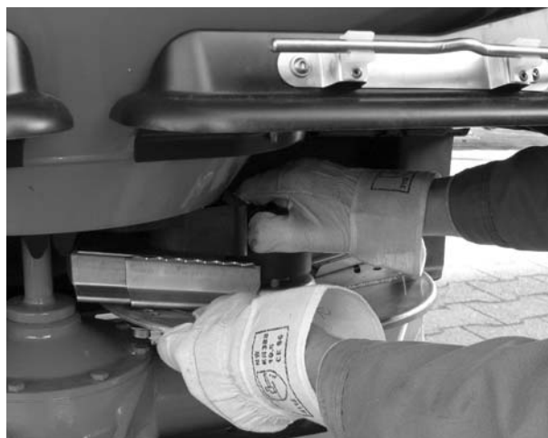
Фиг. 7.7: Завинтете глухата гайка
