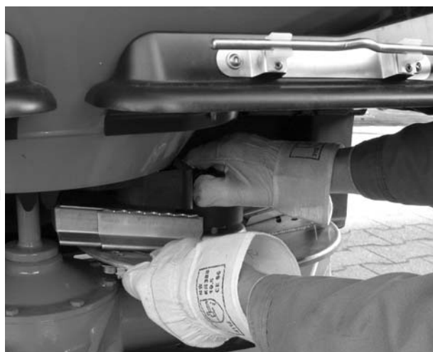
Фиг. 8.12: Развиване на глухата гайка
