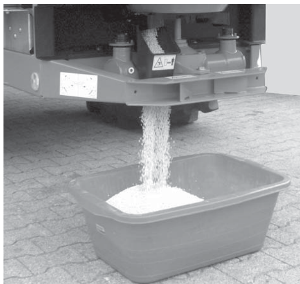
Imagine 7.6: Realizați proba de rotire
