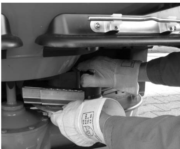
Imagine 8.12: Deșurubați piulița înfundată
