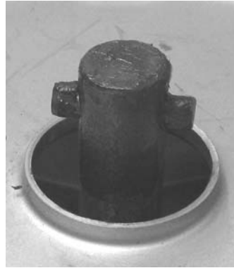
Imagine 5.7: Arborele mecanismului de amestecare
