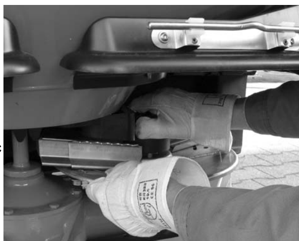
Imagine 7.7: Înșurubați piulița înfundată
