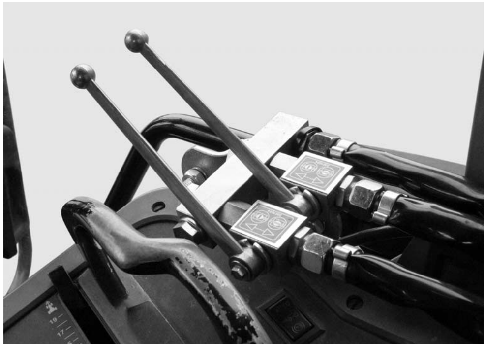
5.21. ábra: A kétutas egység tolattyúmozgató egysége
