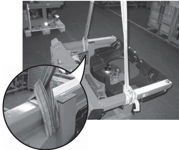
5.1. ábra: A vázkeret felemelése
