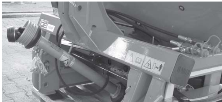
5.25. ábra: A kardántengely és a hidraulikatömlők elhelyezése
