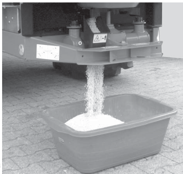
Imagem 7.6: Realizar teste de rotação
