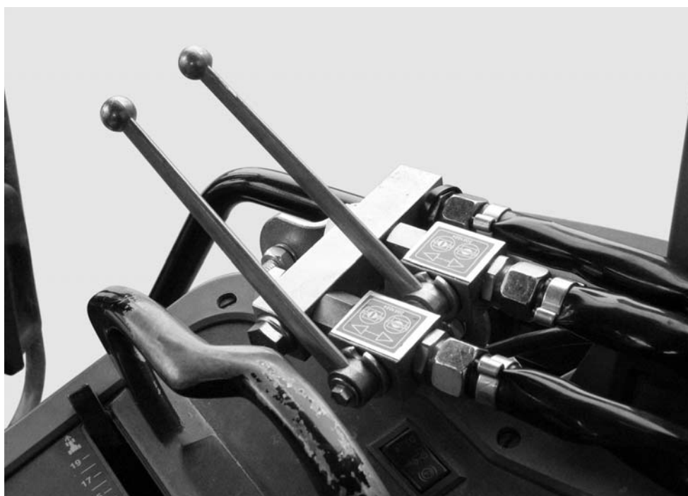
Imagem 5.21: Accionamento da corrediça da unidade de duas vias
