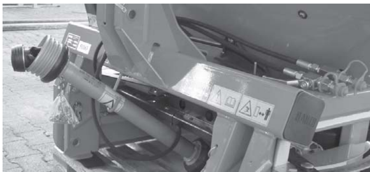
Imagem 5.25: Deposição do veio articulado e das mangueiras hidráulicas
