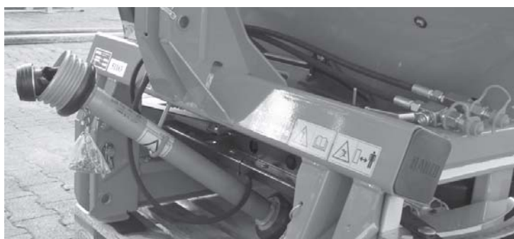
Billede 5.25: Fralægning af kardanakslen og hydraulikslangerne
