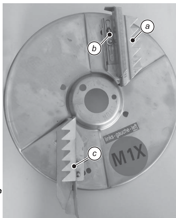
Billede 8.31: Spredeskive med X-spredevinge
