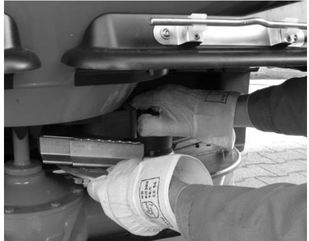
Billede 7.7: Kalotmøtrik strammes
