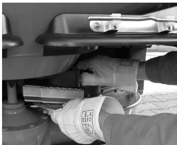
Billede 8.12: Kalotmøtrikken skrues af
