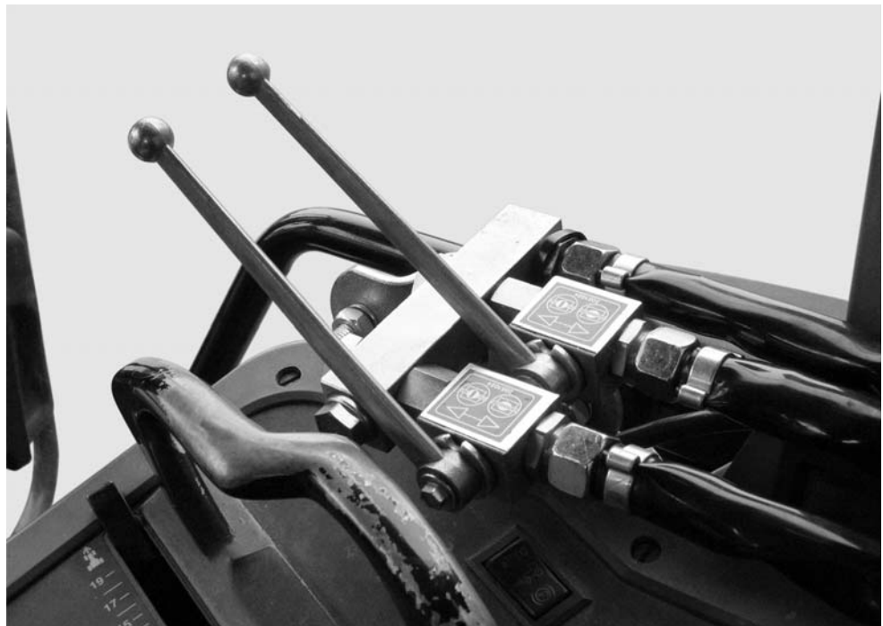
Kuva 5.21: Kaksisuuntaisten yksikön hallintalaitteet
