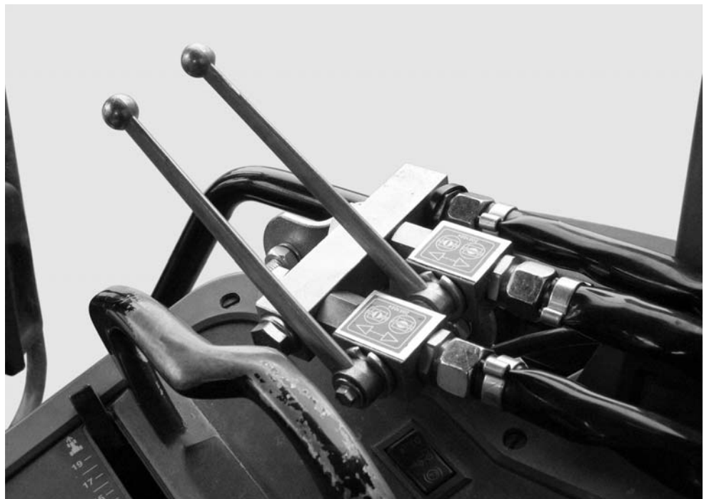
Afb. 5.21: Schuifbediening van de twee-weg-eenheid
