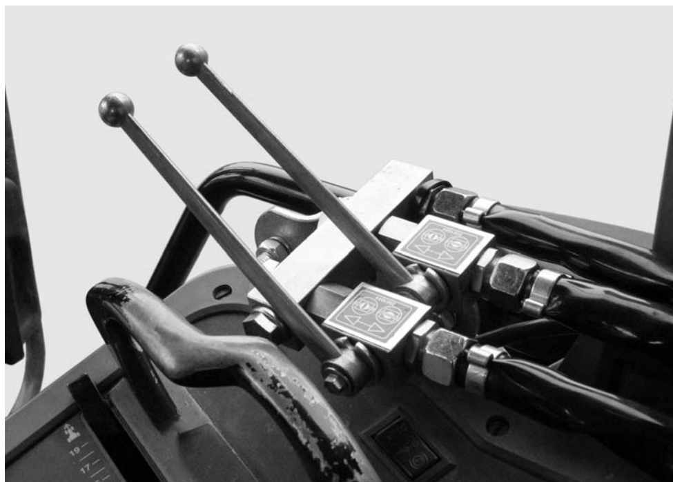
5.21. pav.: Dvikrypčio bloko sklendžių valdymo įtaisas
