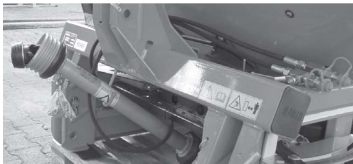
Figure 5.25 : Dépose de l'arbre de transmission et des flexibles hydrauliques
