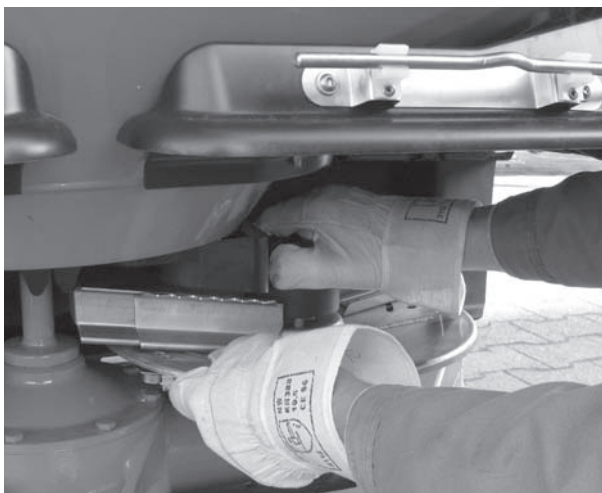
Rysunek 8.12: Odkręcanie nakrętki kołpakowej
