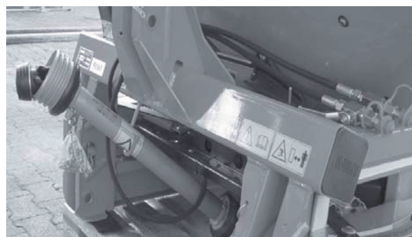
Rysunek 5.20: Uchwyty wału przegubowego
