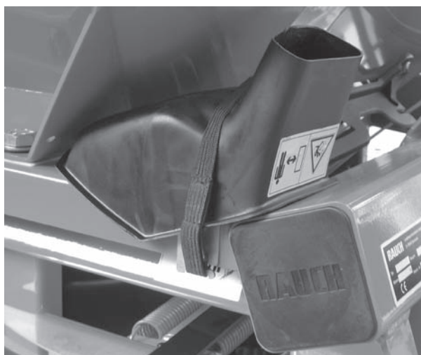
Rysunek 7.3: Zsuwnia próby wysiewu
