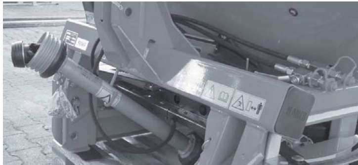
Rysunek 5.25: Przechowywanie wału przegubowego i węży hydraulicznych
