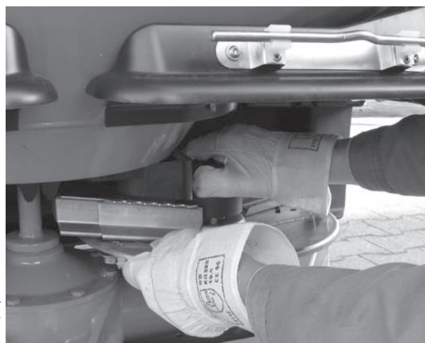
Rysunek 7.7: Dokręcanie nakrętki kołpakowej
