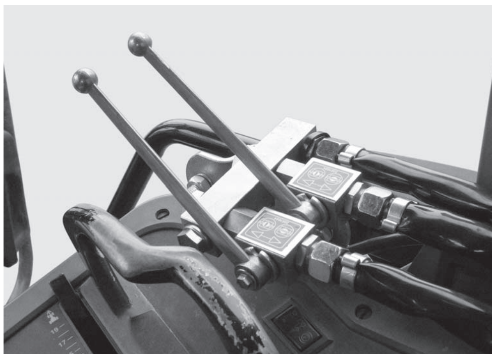
Rysunek 5.21: Układ sterowania suwaków z jednostką 2-drogową
