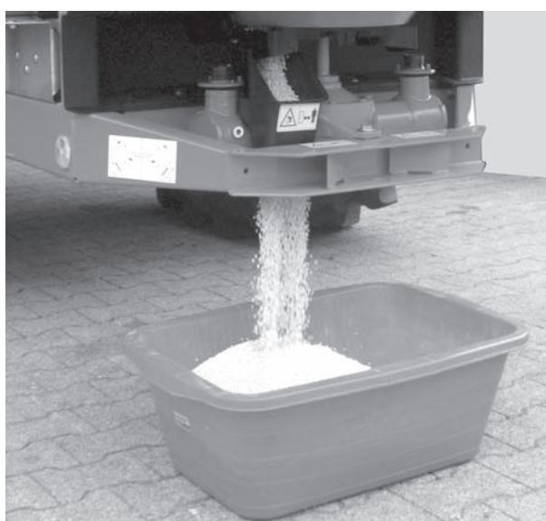
Rysunek 7.6: Przeprowadzanie próby wysiewu
