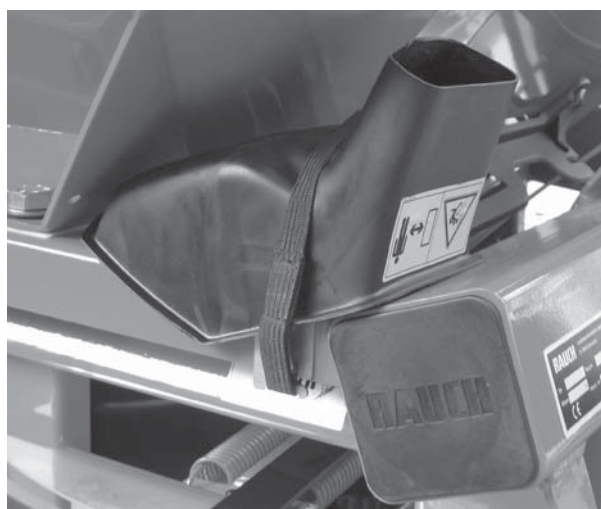
Imagen 7.3: Plano inclinado de prueba de extracción
