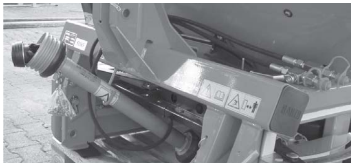
Bild 5.25: Placering av kraftöverföringsaxel och hydraulslangar
