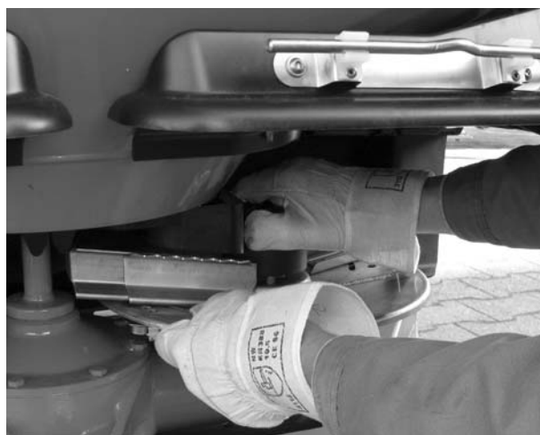
Bild 7.7: Fastsättning av hattmuttern
