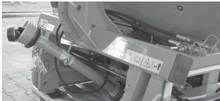
Bild 5.25: Ablage der Gelenkwelle und der Hydraulikschläuche
