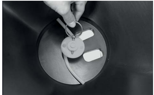
9.1 ábra: Keverőberendezés a tartályban
