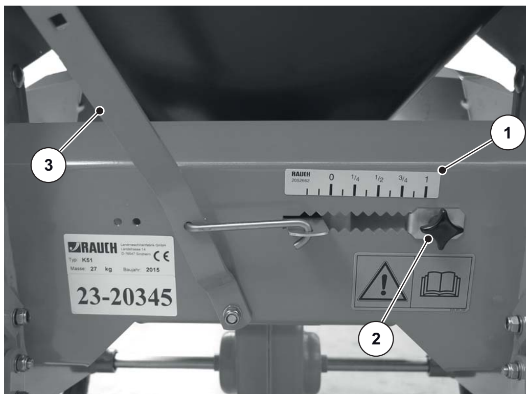
Figure 7.1 : Échelle de réglage des quantités d'épandage
