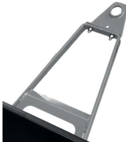
Figure 6.4 : Timon pour le mode tracteur
