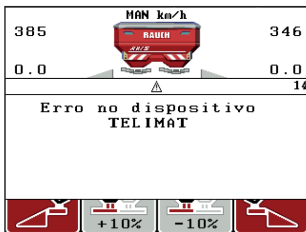
Imagem 5.1: Indicação da mensagem de alarme TELIMAT
