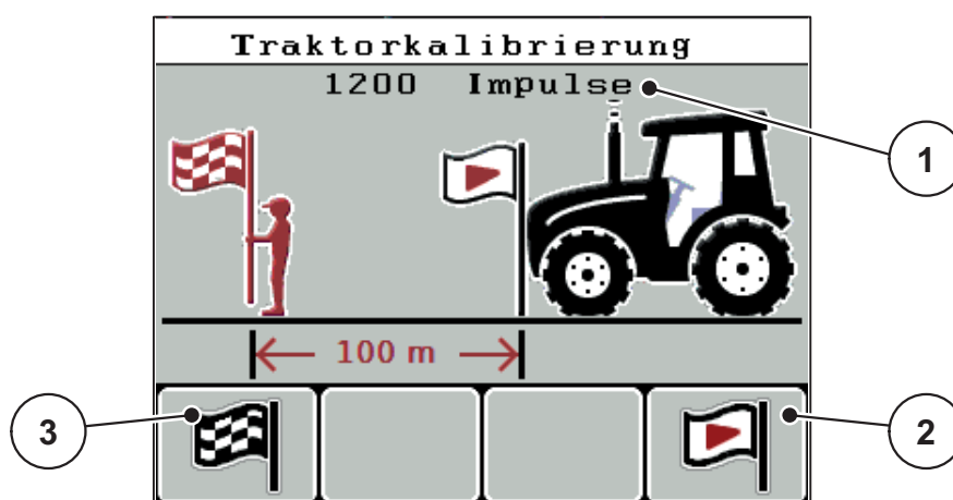
Imagem 4.23: Ecrã de trabalho marcha de calibragem sinal de velocidade
