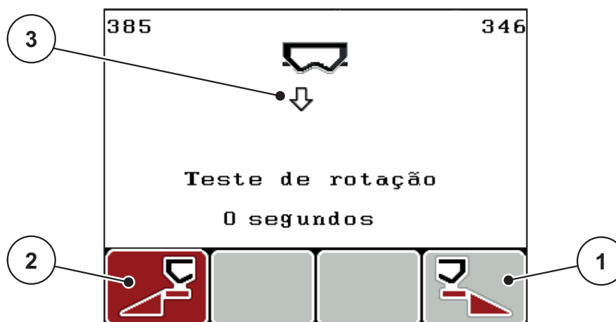
Imagem 4.14: Preparar o teste de rotação do ecrã de trabalho
