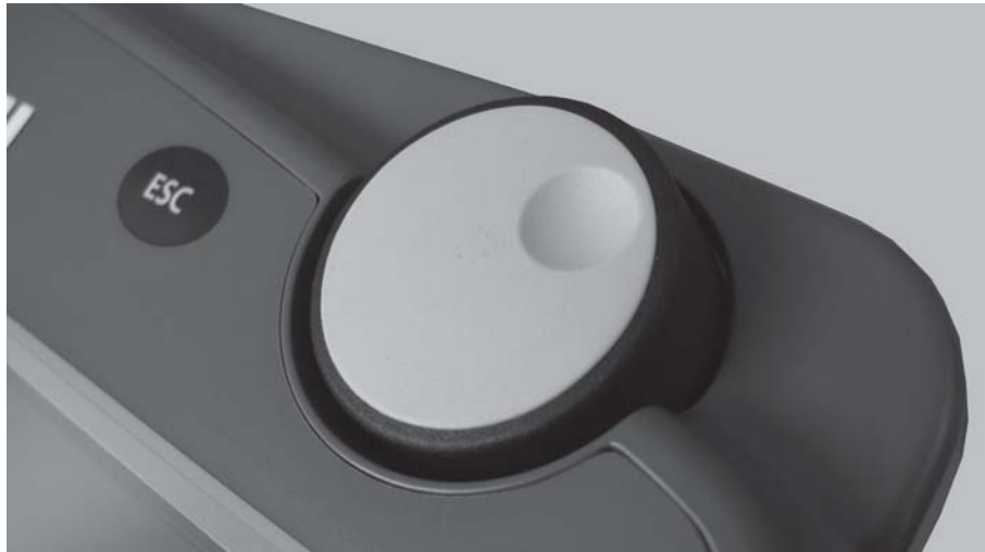
Joonis 2.3: Kerimisratas seadmel CCI 100
