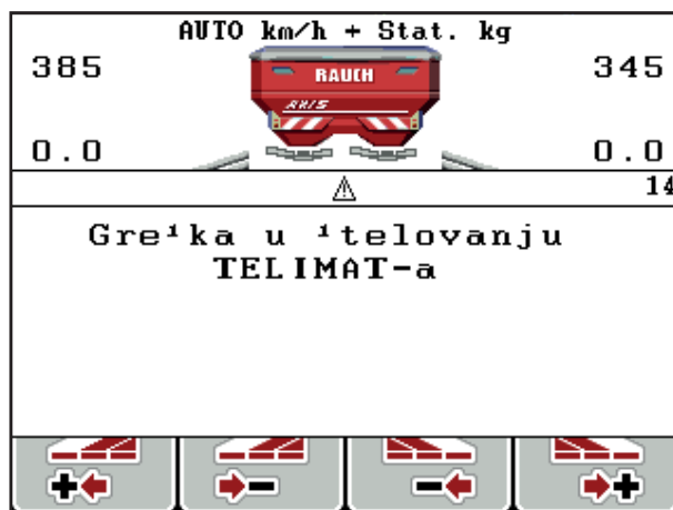
Slika 5.1: Prikaz poruke o alarmu TELIMAT
