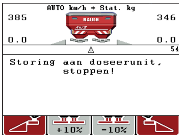
Afb. 6.1: Alarmmelding (voorbeeld doseerunit)
