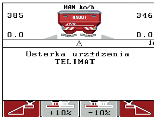
Rysunek 5.1: Wyświetlanie komunikatu alarmowego TELIMAT
