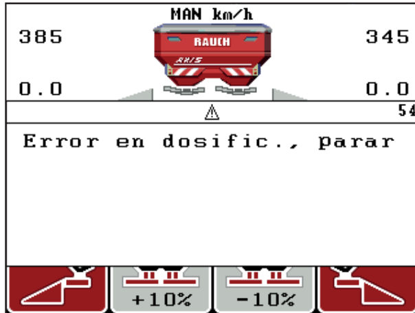
Imagen 6.1: Mensaje de alarma (ejemplo: equipo de dosificación)
