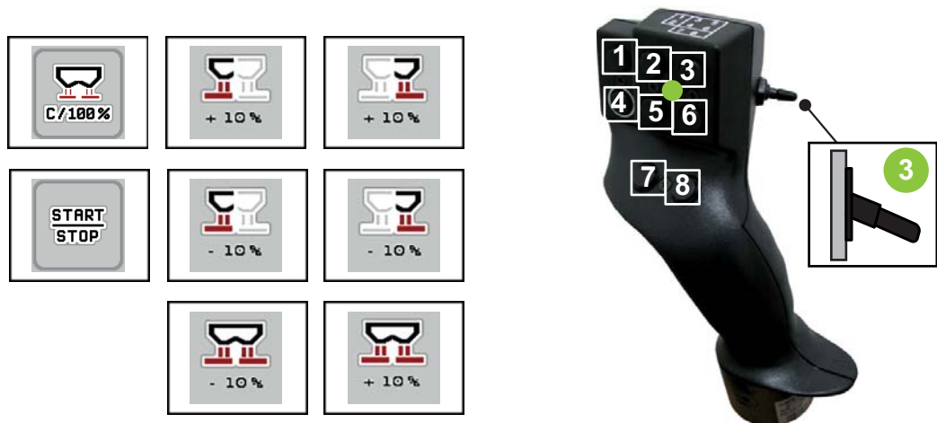
Figure 4.28 : Affectation des touches, niveau 3 (la LED est verte)
