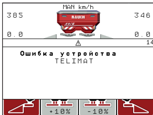
Рисунок 5.1: Аварийное сообщение устройства TELIMAT
