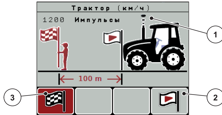
Рисунок 4.23: Рабочий экран «Калибровочная поездка для установки сигнала скорости»
