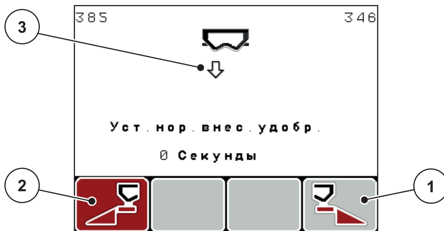
Рисунок 4.14: Рабочий экран «Подготовка установки нормы внесения удобрений»
