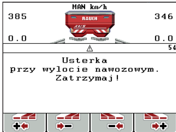
Rysunek 6.1: Komunikat alarmowy (na przykładzie urządzenia dozującego)
