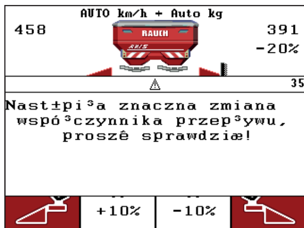
Rysunek 6.2: Komunikat błędu Współczynnik przepływu
