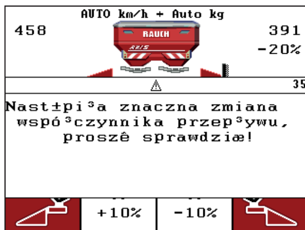
Rysunek 4.12: Komunikat błędu Współczynnik przepływu
