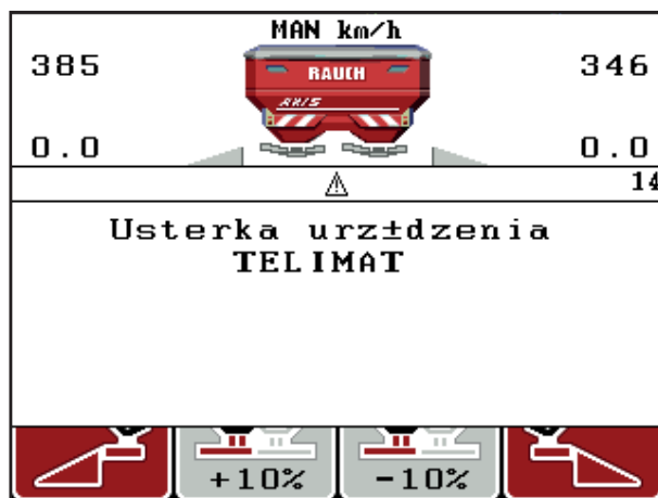
Rysunek 5.1: Wyświetlanie komunikatu alarmowego TELIMAT
