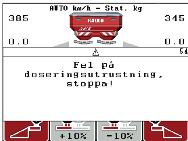
Bild 6.1: Larmmeddelande (exempel doseringsutrustning)
