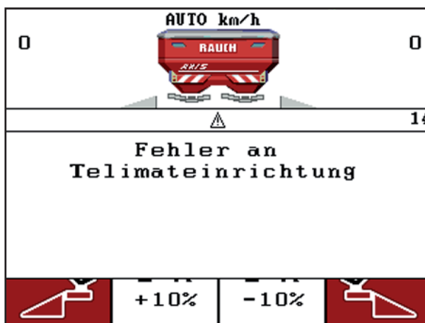
Bild 5.1: Anzeige Alarmmeldung TELIMAT
