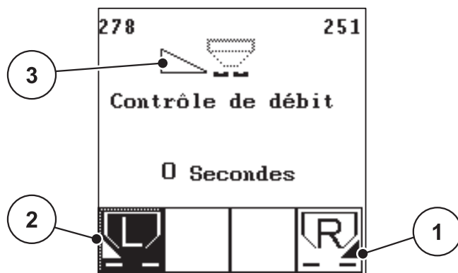
Figure 4.15: Ecran de commande Préparer contrôle de débit
