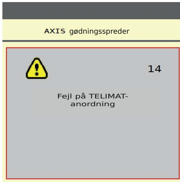
Billede 5.2: Visning alarmmeddelelse TELIMAT TELIMAT med elektrisk fjernbetjening
