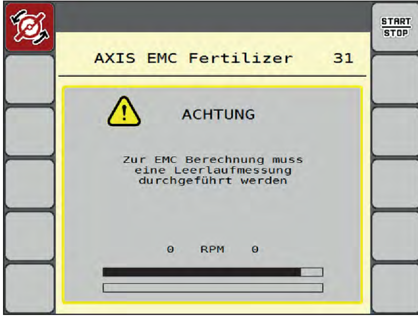
Şek. 43: Rölanti ölçümü alarm göstergesi
